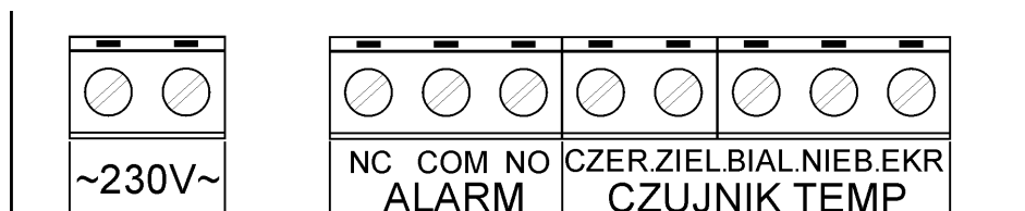
Rys. 1: Rozmieszczenie zacisków połączeniowych termometru.
